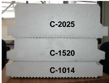
Imagen #2. Láminas de EPS para TERMOLOSAS C.
